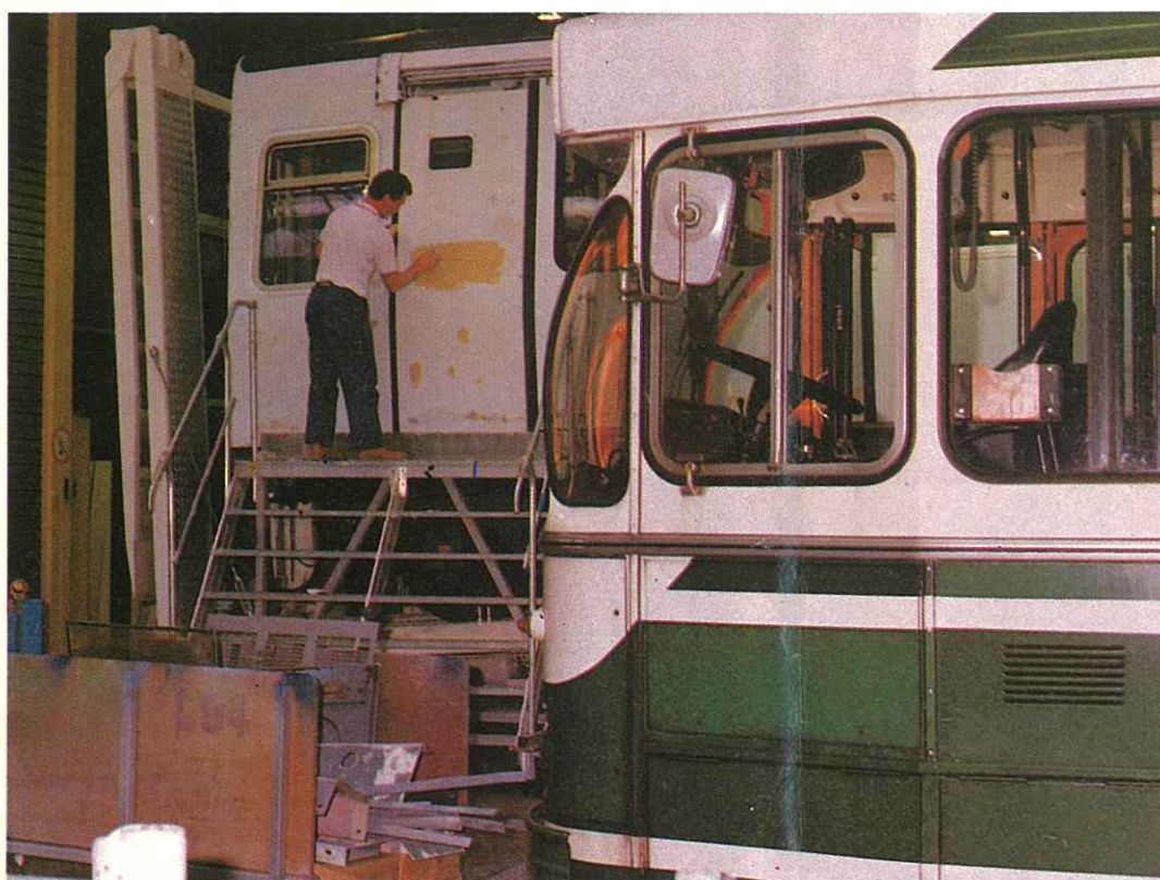
Ponçage, lessivage, mise d'enduit, marouflage et peinture : bus, autobus et métro ressortent de l'atelier « comme neufs ».
