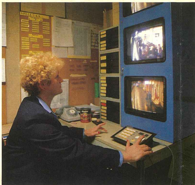
La station (niveau 1) reçoit l'image correspondant à l'anomalie détectée.
