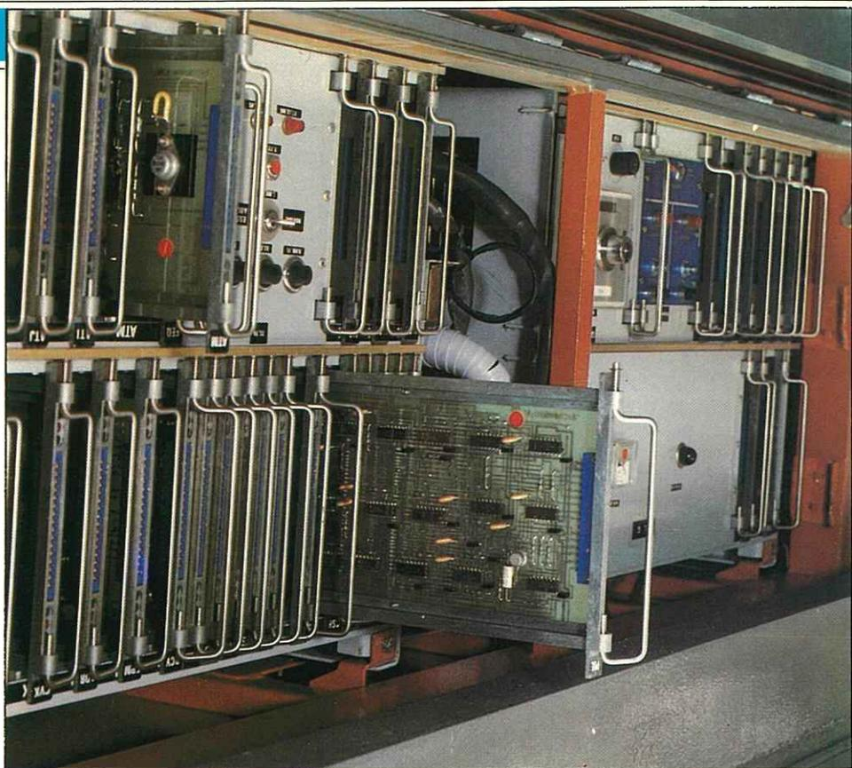
*Coffre logique du hacheur de courant ; au premier plan, carte électronique de commande et de régulation des équipements de puissance.*
