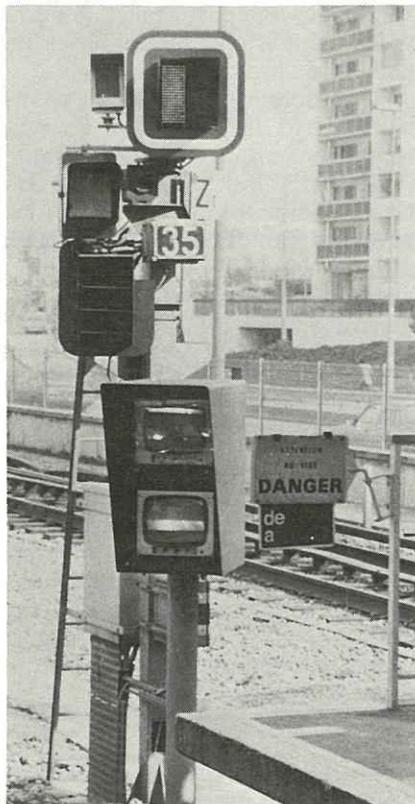
3. Signal de manœuvre à fibres optiques.
