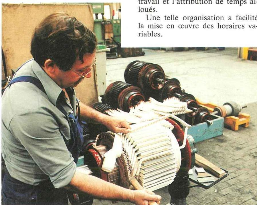
Atelier de Révision Centralisé (ARC) de Fontenay : mise en place des sections d'induit sur un moteur de traction MP3 (matériel pneu).
