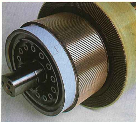
Le collecteur : le talon d'Achille du moteur à courant continu.
