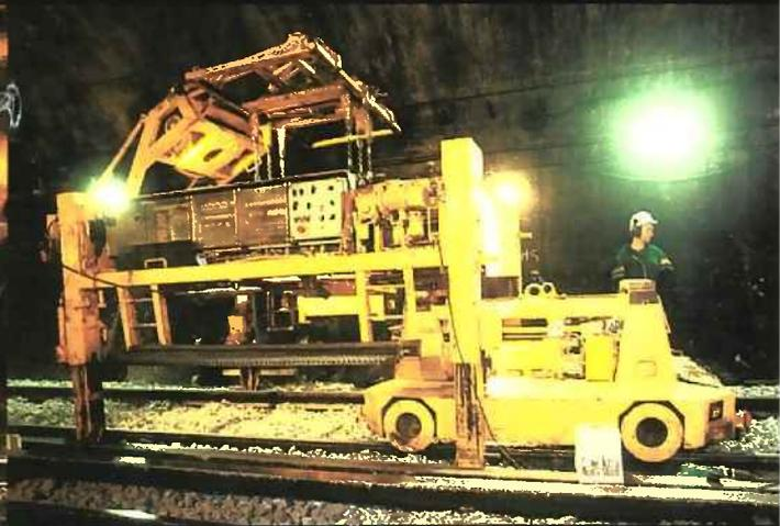
4. Lorry automoteur, ce matériel permet d'acheminer les anciennes et les nouvelles traverses.
