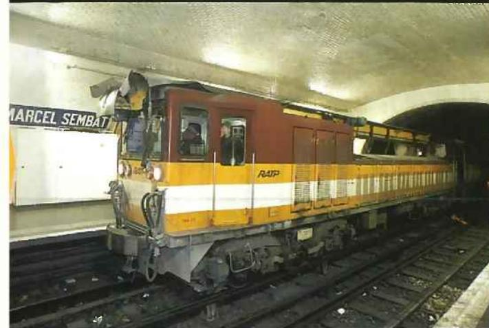
1. Arrivée des trains sur le chantier. D'une longueur totale de 75 mètres, ces trains comprennent un wagon pour l'énergie, qui fournit l'électricité au chantier (l'alimentation de la voie est coupée). Ici, le tracteur à marche autonome.
