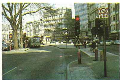
Liège, un site propre en centre-ville qui a fait ses preuves. L'aménagement a débuté dès 1966 et s'est fait au fur et à mesure des possibilités. Sur une longueur de 4,9 km, il offre 1,9 km en position axiale dans le centre et 2,3 km combinés à une voie rapide en position axiale, un à voie unique en position axiale et un à double voie en position unilatérale.
