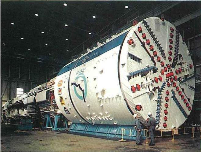
Vue de l'ensemble du tunnelier dans l'usine de construction à Kiel. Longueur : bouclier seul, 11m ; 80 m avec le train suiveur. Poids total, 1 100 tonnes. C'est à partir d'un puits de service, au bord du bassin de l'Arsenal, que le tunnelier de Météor a commencé sa course à l'automne 1993. Depuis il a creusé et construit plus de 3 km de tunnel à 2 voies.
