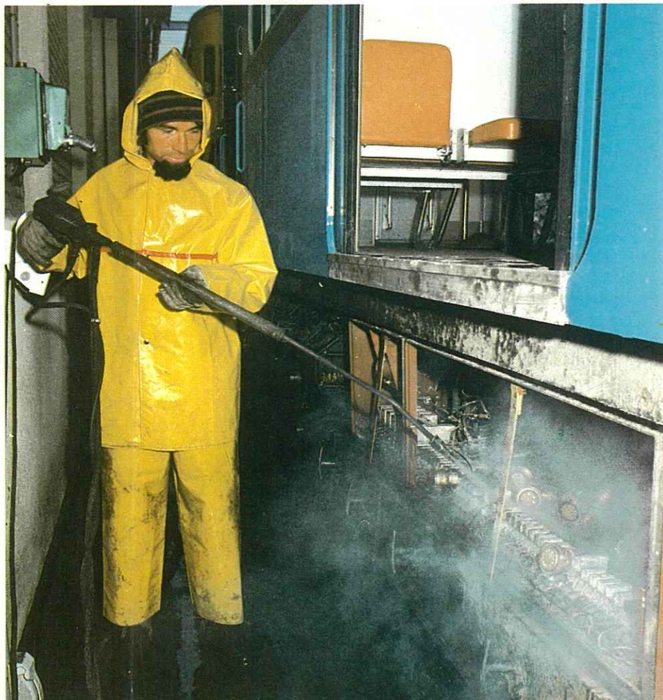
Nettoyage à la vapeur des coffres électriques aux ateliers de Choisy.
