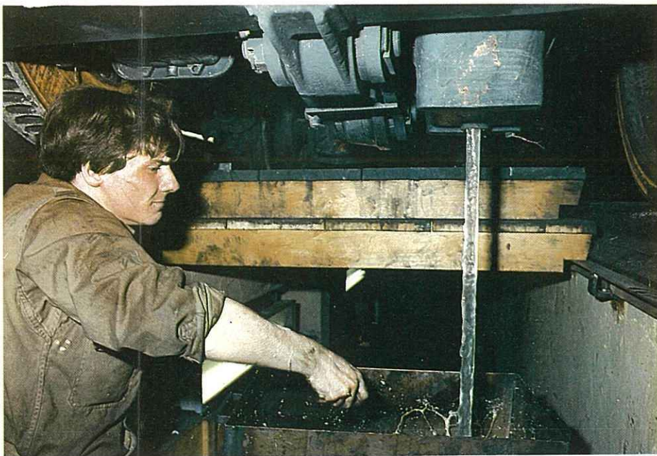
La vidange d'un réducteur : plus d'eau que d'huile !
