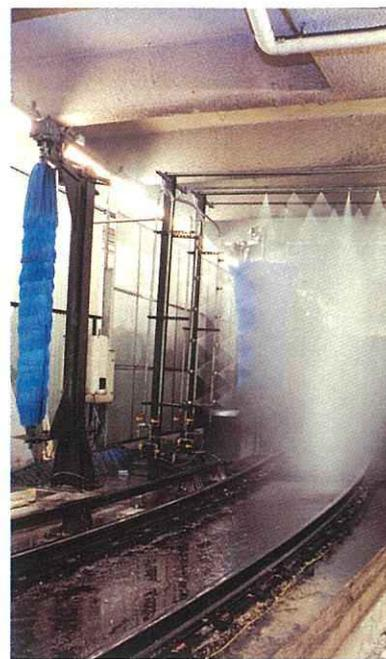
plus réduit. Le produit lessiviel utilisé sous forme de mousse, la forme des brosses, les produits de rinçage permettent de limiter la quantité d'eau utilisée à un seuil acceptable pour préserver la pérennité du matériel. L'installation de cette machine est prévue pour la fin de l'année 1993, en tunnel, à proximité de la station Château de Vincennes.
