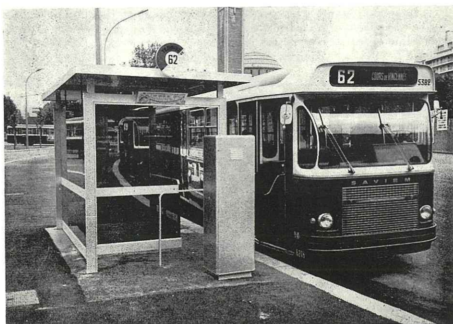
Détail d'un abri du terminus (au premier plan, la « borne » du système de commande automatique des départs)
