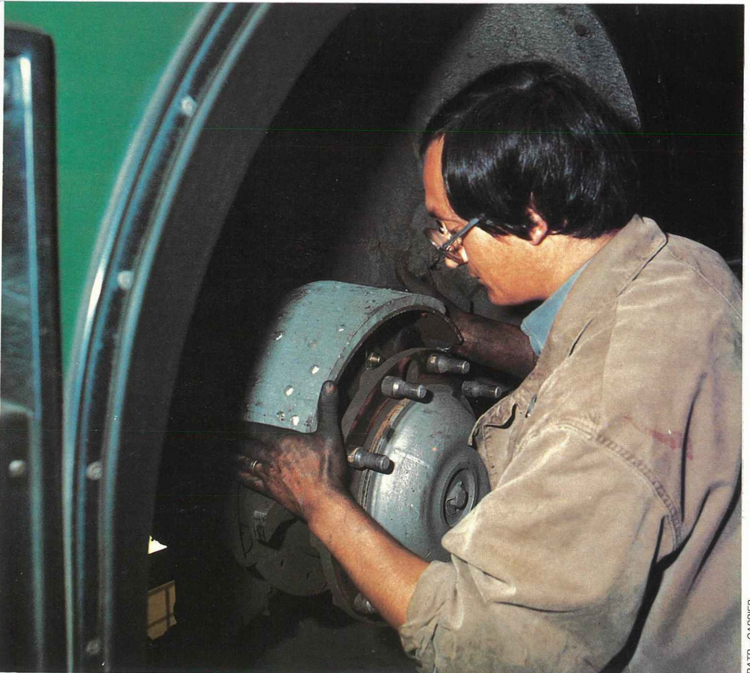
Remplacement des plaquettes de frein sur un bus
