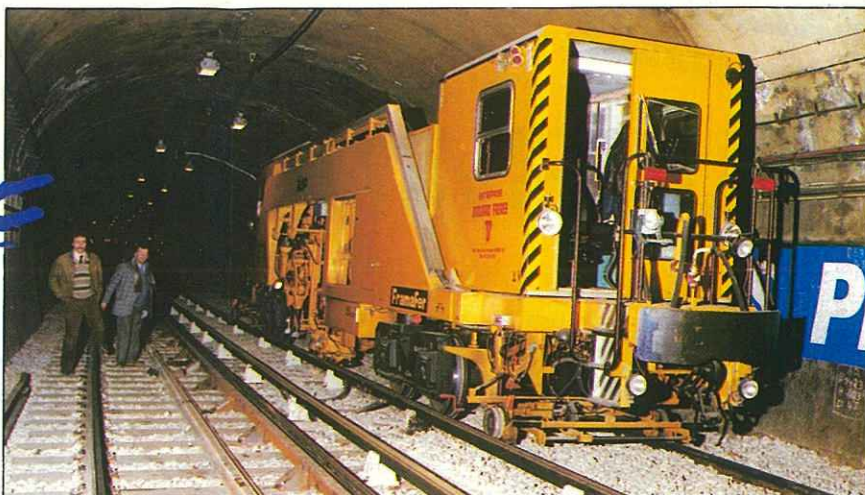
La nouvelle dresseuse-niveleuse qui assure le bourrage mécanique lourd de la voie renouvelée à Saint-Fargeau (ligne 3 bis).
