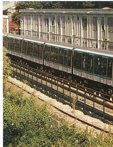
La version du MP 89 sans cabine de conduite destinée à la ligne 14 du métro (Météor).
