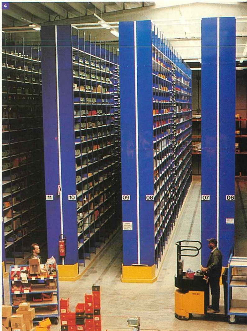
Sur un chariot de manutention avec terminal d'ordinateur embarqué, l'opérateur va repérer les articles grâce à la lecture optique du code-barres d'emplacement qui détermine le lieu de stockage.
