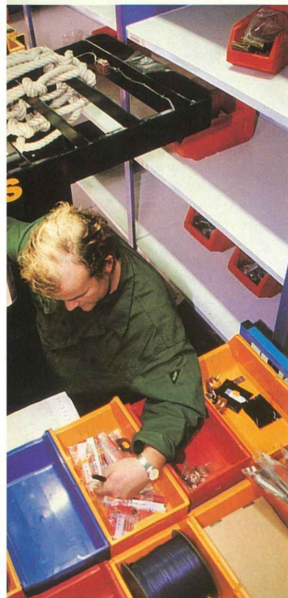
Sur un chariot de manutention avec terminal d'ordinateur embarqué, l'opérateur va repérer les articles grâce à la lecture optique du code-barres d'emplacement qui détermine le lieu de stockage.
